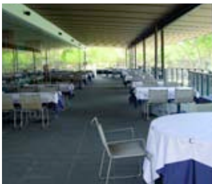
Distribución adecuada del mobiliario en restaurante, con suficiente espacio de circulación para una persona en silla de ruedas y fácil incorporación a cada una de las mesas
